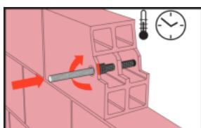
Τοποθετήστε το αγκύριο με περιστροφική κίνηση στη γεμάτη οπή. Μερική ποσότητα υλικού πρέπει να εξέλθει από την οπή. Σημείωση: το αγκύριο πρέπει να τοποθετηθεί μέσα στο χρόνο ενέργειας του υλικού.
